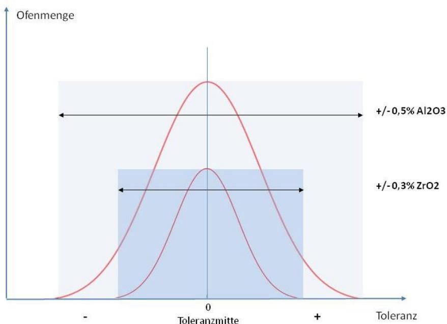
Bedingt durch den großen Schwund während des Sinterns lassen sich Maßtoleranzen nicht vermeiden. Im Wesentlichen resultieren diese aus dem Material (Korngröße), der Sintertemperatur und der Lage der Bauteile im Ofen. Je nach Lage werden die Bauteile unterschiedlich früh und unterschiedlich lange mit der entsprechenden Temperatur konfrontiert, was sich entsprechend auf den Schwund auswirken kann.
