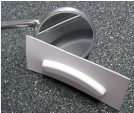
Bild 1 Tiefgezogene Verbundfolie aus Zirkonoxid und Pulverstahl.
