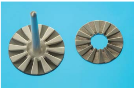
Bild 3 Demonstrator Fadenführer im grünen (mit Anguss) und gesinterten (rechts) Zustand, Bauteildurchmesser 20 mm. Design: Rauschert Heinersdorf-Pressig GmbH
